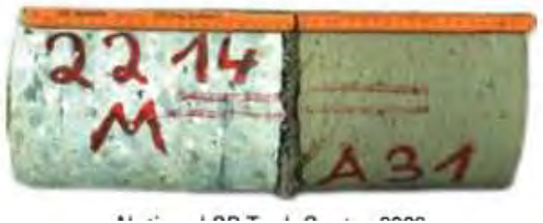
ภาพที่ 2.4 การใช้วัสดุแผ่นใยเคราะห์ในการเสริมผิวทางซีเมนต์คอนกรีต (Cackler et al, 2018)
